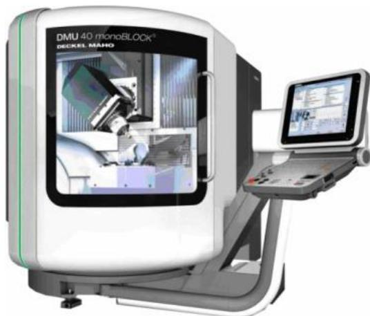
DMG DMU 40 monoBLOCK je univerzalna kompjuterski upravljana CNC (Computer Numerical Control) glodalica koja omogućava istovremeno upravljanje u 3 do 5 osi čime je omogućena izrada najsloženijih dijelova u samo jednom stezanju. Time se postiže visoko učinkovita i optimalna strojna obrada, kako pojedinih dijelova, tako i serije komada. Pretežno se izrađuju dijelovi ravnog oblika (poravnavanja, utori, žljebovi), profili, navoji, zubi, kalupi, alati pa sve do izrade rotora turbina.
