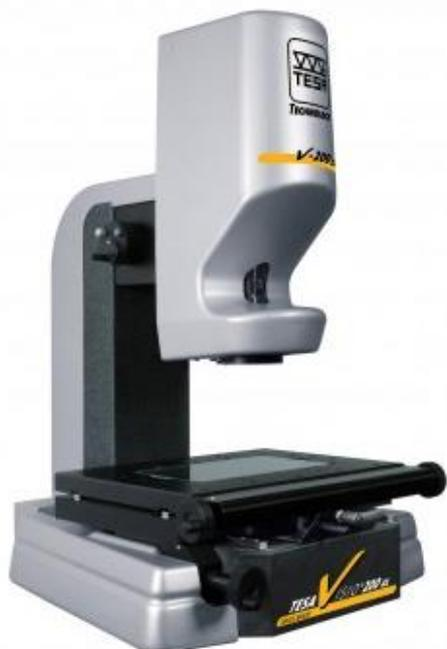
TESA VISIO 200 je optički uređaj za beskontaktno mjerenje koji omogućava mjerenje formi i oblika manjih predmeta ili mekih materijala kod kojih mehaničko mjerenje nije moguće.
