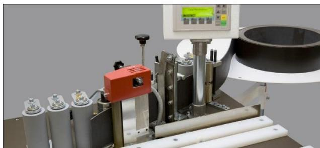
Spremnik ljepila je smješten ispod radne površine a vrijeme zagrijavanja je 4 do 5 min. Stroj radi s materijalima debljine od 8 do 115 mm, širine minimalno 30 mm i duljine minimalno 200 mm. Debljine rubne trake mogu biti 0,4 do 3,0 mm. Najmanji unutarnji radijus je 25 mm.
