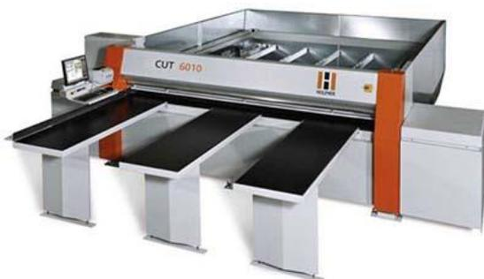
CNC raskrajač HOLZ-HER CUT 6010 posjeduje sve karakteristike za brzo, precizno i ekonomično rezanje drvnih ploča. Ima stabilne radne stolove (1.800 x 600 mm) za jednostavno i pažljivo rukovanje drvnim pločama, radni prostor od 3100 x 3100 mm te brzinu rezanja do 60 m/min. Također, posjeduje i pneumatski upravljane stezaljke za sigurno stezanje radnih komada pri teškim uvjetima rada.
