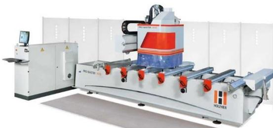
Obradni centar HOLZ-HER PRO-MASTER 7018 je moderni CNC stroj za obradu drveta. Posjeduje snažno vreteno snage 7,5 kW i omogućava obradu u 4 polja s duljinom u Y osi od 1250 mm i visinom u z osi do 478 mm.
