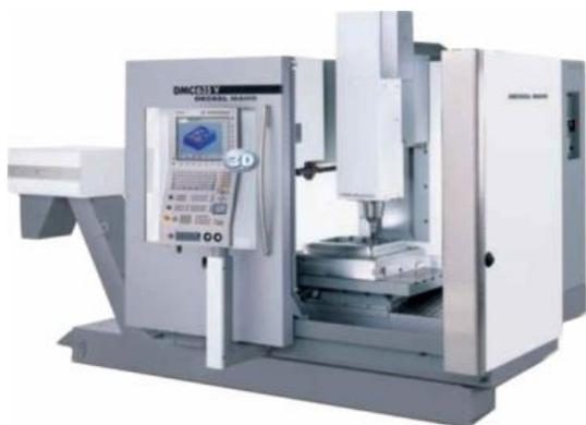
DMG DMC 635 V je vertikalna CNC glodalica za strojnu obradu metala odvajanjem čestica s upravljanjem u 3 osi. Os glodala stoji vertikalno (okomito), dok radni stol na kojem se steže komad stoji vodoravno. Pogodna je za čeno glodanje, glodanje utora, kanala, rubova te profilno glodanje.
