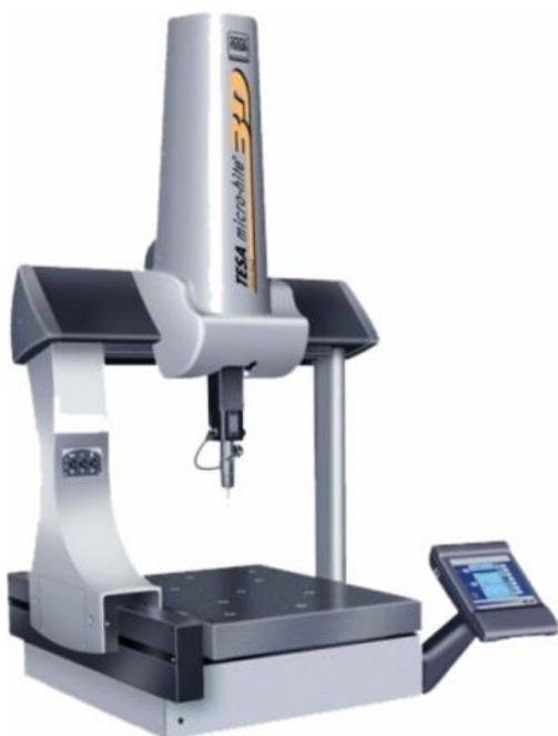
**Tesa Micro-Hite 3D DCC je koordinatni mjerni uređaj koji služi za prostorno mjerenje (x,y,z) složenih tijela (duljina, kutova, oblika, međusobnog položaja ploha i provrta). Omogućava složena mjerenja s jednim postavljanjem proizvoda na mjerni stol, čime se izbjegavaju pogreške namještanja. Pomicanje glave s ticalom se vrši pomoću elektromotora, a upravlja se preko džojstika.**
