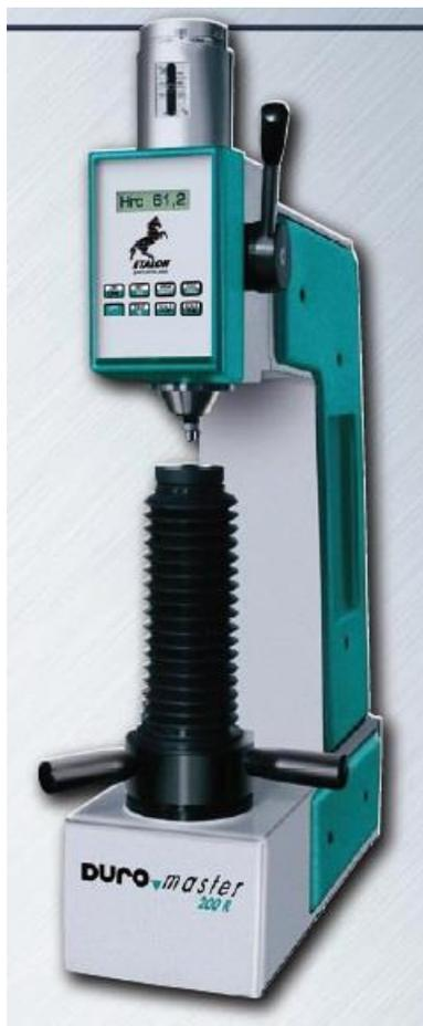
ETALON DUROMASTER 200 RB je uređaj za ispitivanje tvrdoće svih materijala i tvrdih legura kao što su čelik, wolfram-karbid, aluminij, mesing i bakrene legure, ali i plastičnih materijala.
