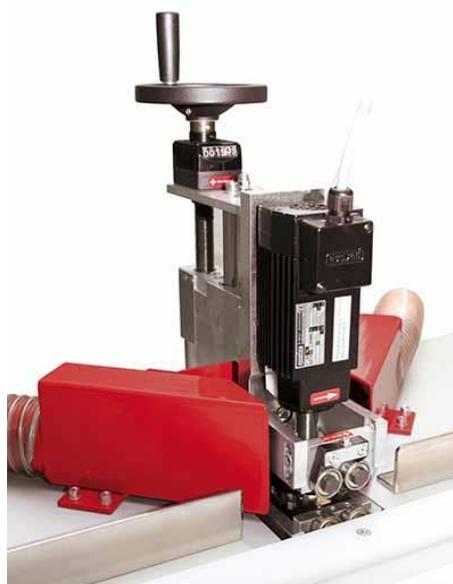
Glodalica rubne trake Lange Maschinenbau tip B 600 je idealna nadopuna krivolinijskoj ljepljici rubova Lange Maschinenbau tip B 580 K.
