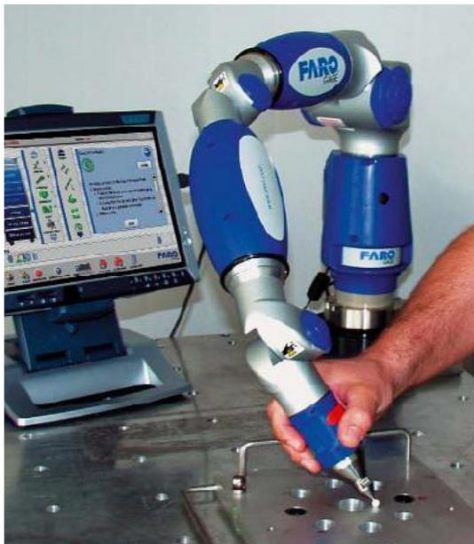
Mjerna ruka FARO GAGE standard je prijenosni 3D koordinatni mjerni uređaj s radnim rasponom od 1,2 m i mjernom točnošću od  $\pm 0,01$  mm. Služi za jednostavno mjerenje i kontrolu kvalitete složenih objekata i predmeta. Pomagala za učvršćivanje omogućavaju brzu i jednostavnu primjenu, kako na radnom stolu, tako i direktno na terenu gdje je to potrebno.
